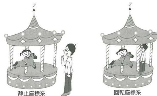
図 2.7 静止座標系と回転座標系
