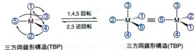
図 3・14 5 配位超原子価化合物の位置異性化機構
